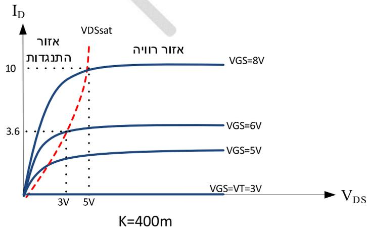
אופיין מבוא עבור אזור רוויה :  $V_{DS} > V_{GS} - V_T$
